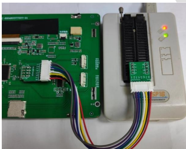
图 9-5 存储芯片与烧录器连接图
